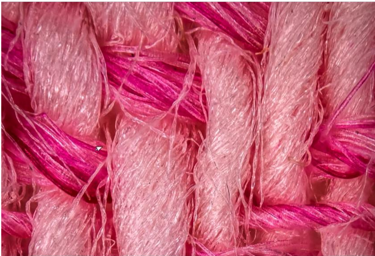
« Échantillon de Fuchsine sur coton » in M.P. Schützenberger, Traité de matières colorantes (1867) (image en ultra haute résolution réalisée dans le cadre de la ChromoBase)
